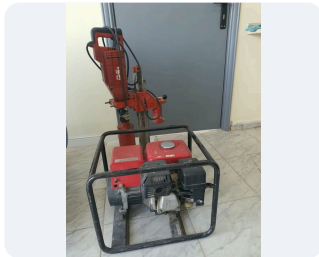
جهاز استخراج العينات اللبئية
