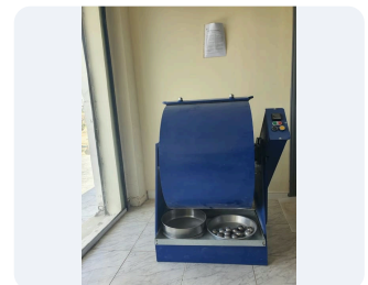
جهاز لوس أنجلوس للتآكل
