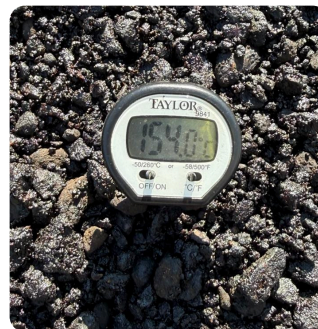
قياس حرارة الخلطة لحظة الفرد
