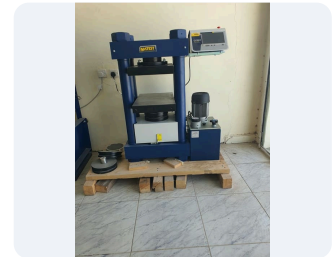
جهاز فحص الضغط الرقمي
