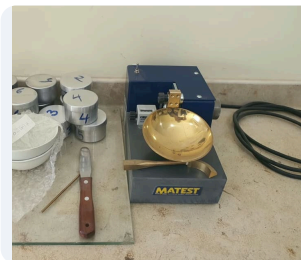
جهاز كاساغراندي لحد السيولة
