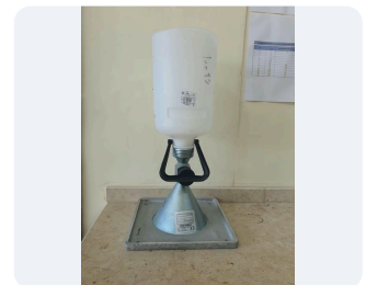
جهاز المخروط الرملي للكثافة الحقلية
